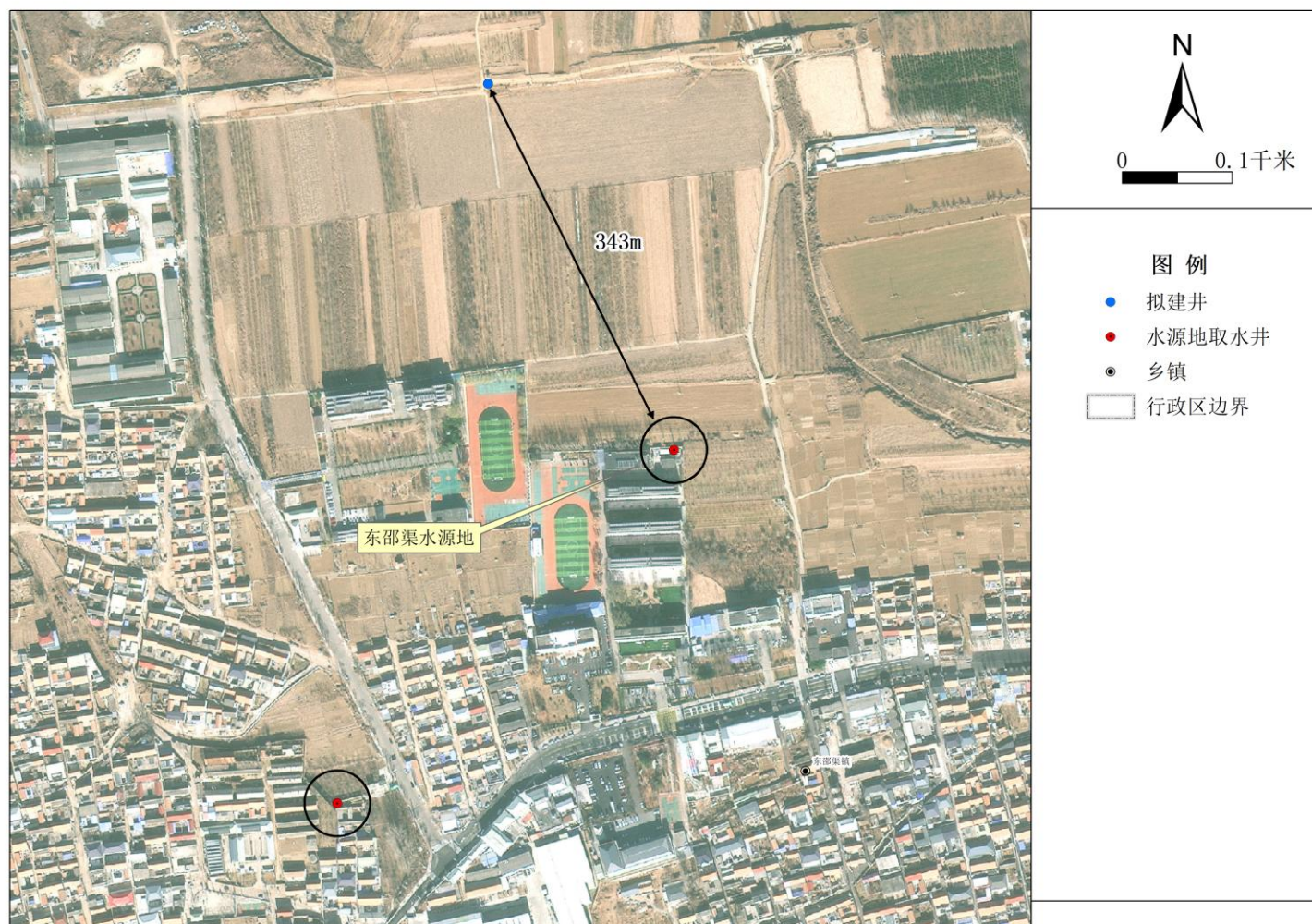
图 4.2-5 东邵渠水源地保护区周边拟建井位置示意图
