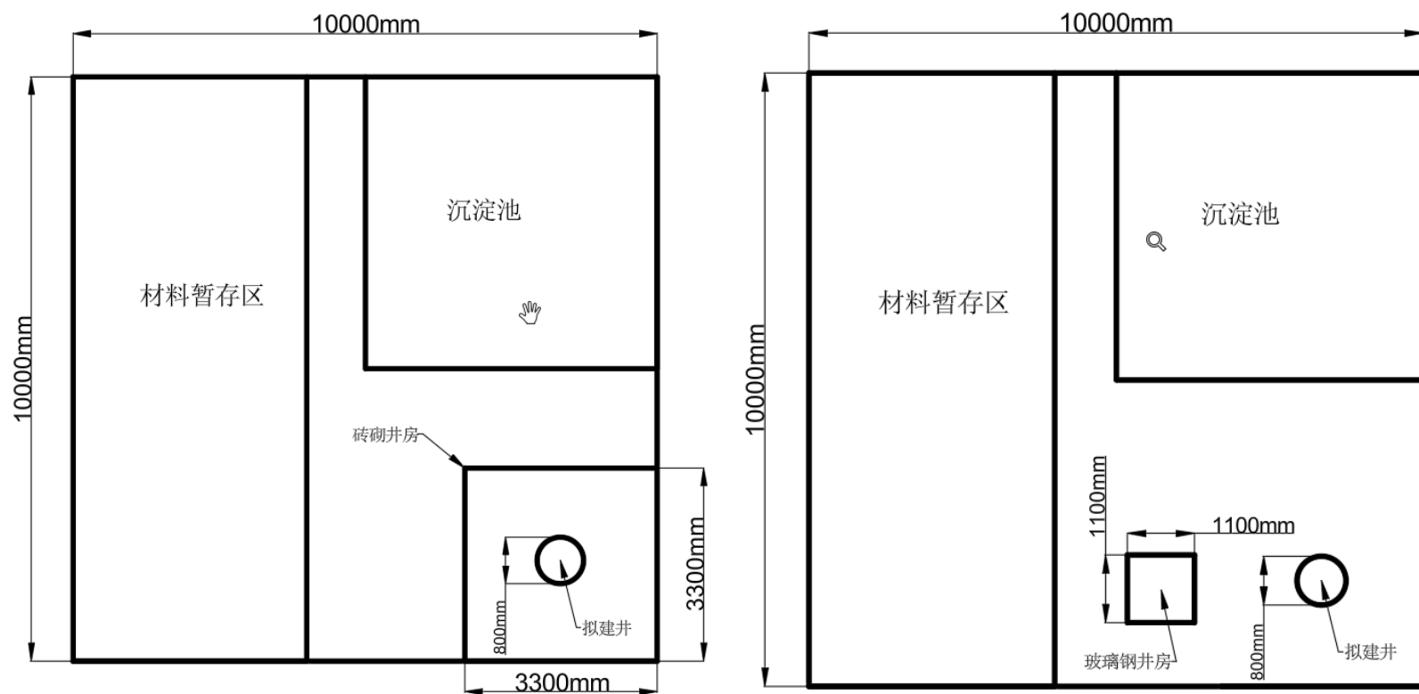
图 2.3-2 拟建井施工典型平面布置示意图
